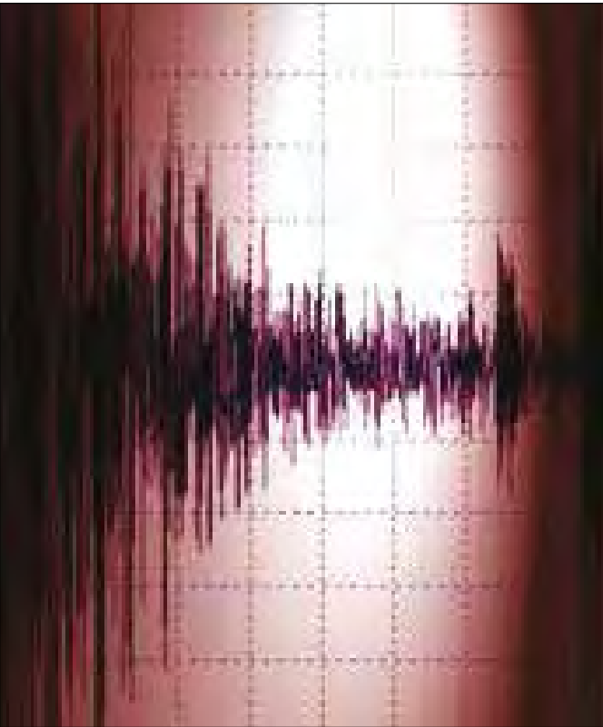
Gráfica producida por un Sismógrafo. El Sismograma registra la intensidad, duración y otras características de un movimiento sísmico. Imagen de uso público en Internet.
