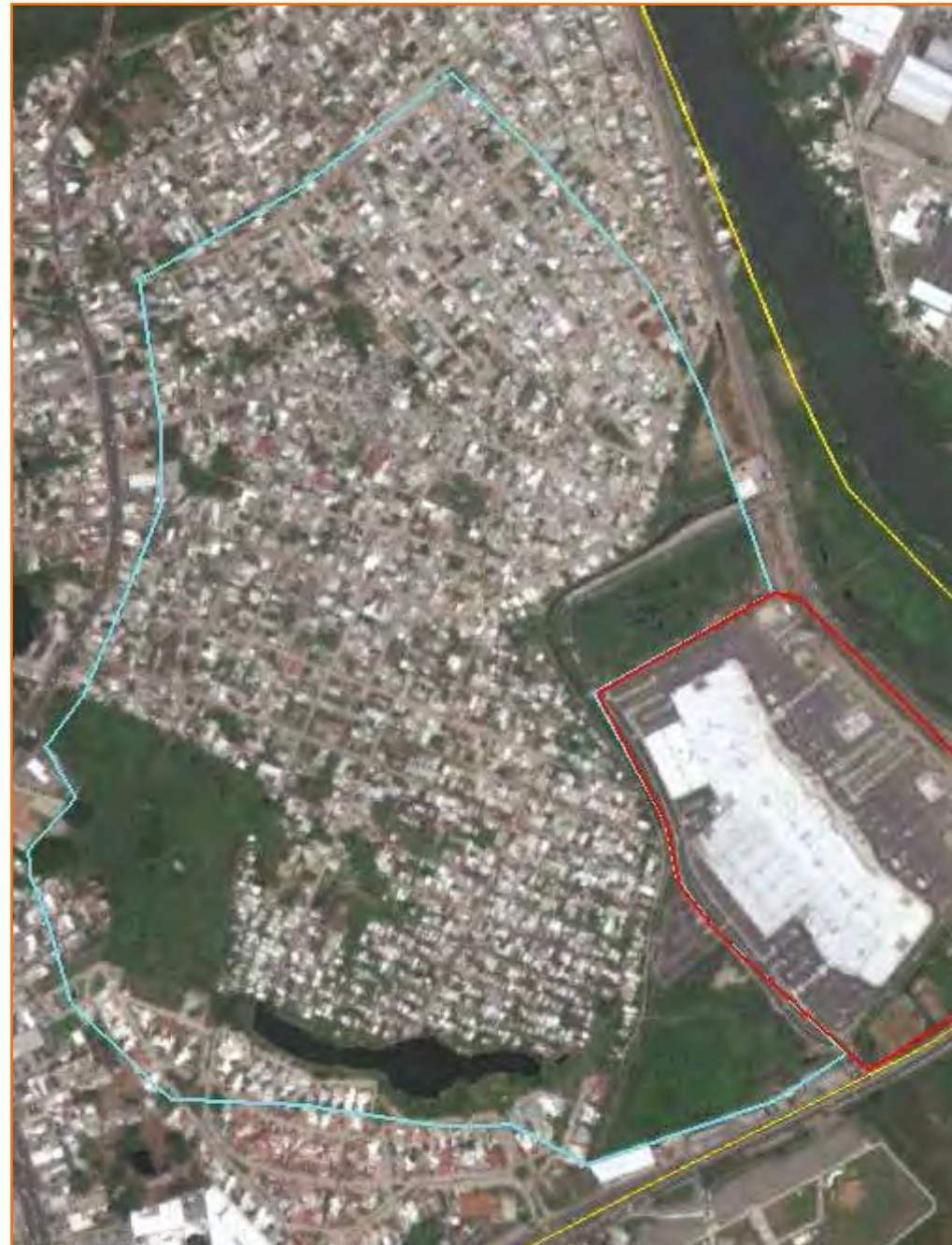
Figura 5.2.20. Zona de amortiguamiento hidráulico en la colonia Asunción Castellanos. En la imagen se aprecia una importante zona anegamiento (color azul) donde se incluye a la calle Asunción Castellanos. Originalmente el área conformaba una zona de amortiguamiento hidráulico para las crecidas del río Carrizal y como parte de un brazo de la Laguna de Las Ilusiones. Sin embargo, como todo asentamiento irregular en Villahermosa este se estableció sobre una zona inundable. En color rojo se aprecia además el polígono del relleno de Plaza Sendero.
